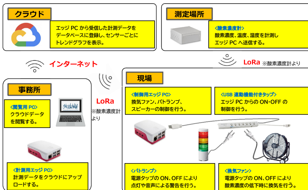
【酸素濃度監視システムの機器構成概要】
