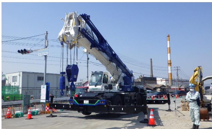
バッテリー式フル電動ラフテレーンクレーン「EVOLT eGR-250N」
