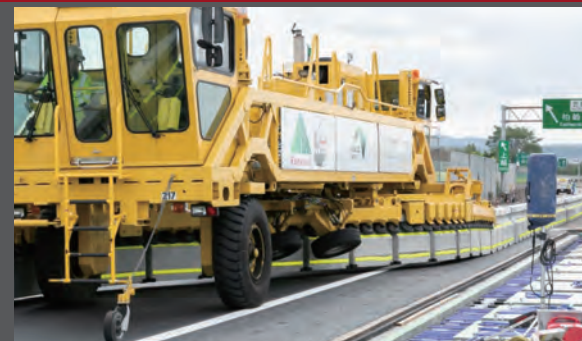
ロードジッパーシステム(Road Zipper System)とは・・・LINDSAY(アメリカ)のシステムで、コンクリート製防護柵の設置位置を、専用の防護柵切り替え車両で移動させることができるシステム。
